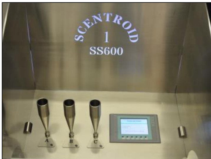
Figura 4. Olfattometro Scentroid mod. SS600 – postazione valutatore
