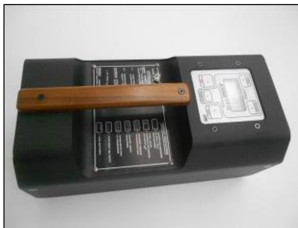
Figura 5. Analizzatore portatile di H_2S Jerome 631-XE
